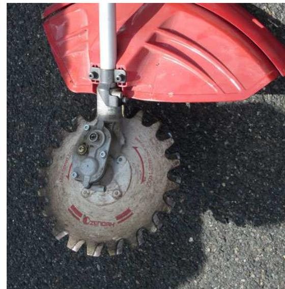
Débroussailleuse à lames réciproques
