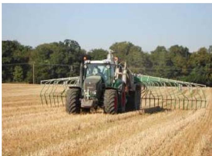
Exemple de matériel d'épandage de boues liquides (Chauconin-Neufmontiers)
