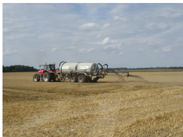
Recyclage agronomique : épandage avec une tonne à lisier équipée de buses/palettes (lagune de Chevru)
