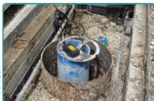
Le niveau des nappes est mesuré par des piézomètres équipés de sondes de niveau.
