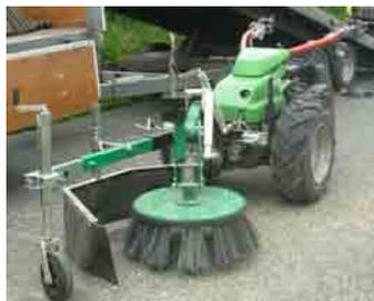
Les brosses de désherbages peuvent être installées sur une balayeuse mécanique, un tracteur ou un porte-outil.
