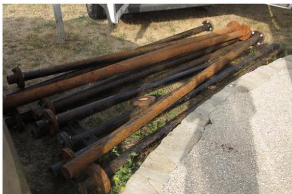
*Ancienne colonne de pompage corrodée à raccord boulonné*
